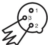
Le bouchon de terminaison réduit les erreurs de signal et évite les problèmes de transmission de signal et les interférences. Il est toujours recommandé de connecter un bouchon DMX (résistance 120 Ohm  $\frac{1}{4}$  W) entre la broche 2 (DMX-) et la broche 3 (DMX+) de la dernière unité.
